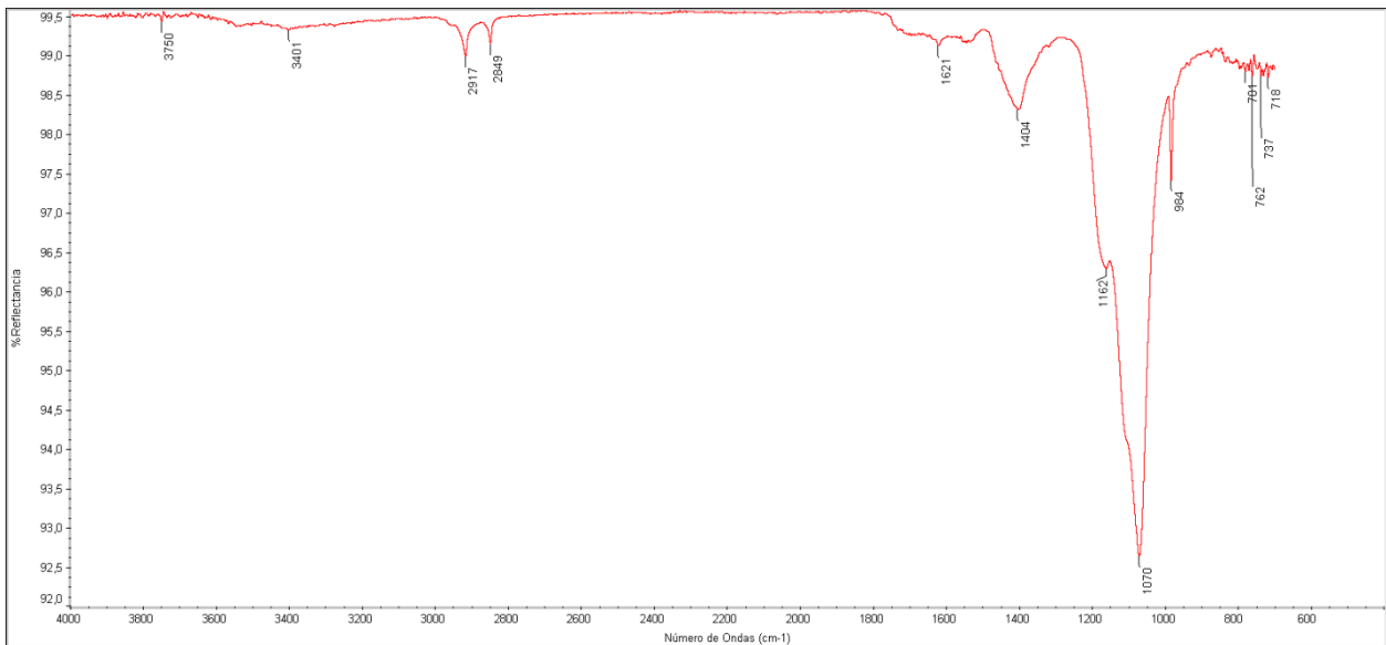
Figura 5. Espectro IR de la muestra LPC-162-07.
