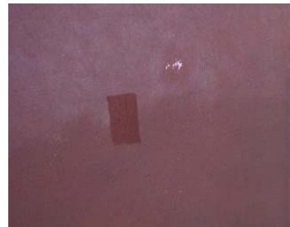
Detalle, pruebas con barniz mate 90% con alifático 10% en el fondo. (G. Reveco. 2013). Cota LPCD 593.040
