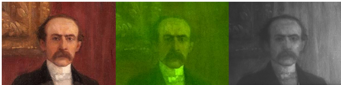
Fotografía con luz visible (V. Rivas, 2013); Reflectografía IR (M. Pérez, 2013); Fotografía de fluorescencia UV (V. Rivas, 2013); Detalle del rostro del Presidente Balmaceda.
