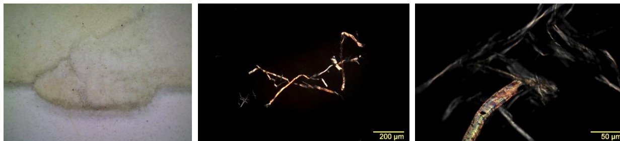
Figura 2. Caracterización de la muestra UPGD-004-01. Zona de toma de muestra de soporte, observación bajo luz normal (50X; Izquierda). Sección longitudinal de las fibras, bajo luz transmitida polarizada (100X; Centro y 400X; Derecha). (Archivo fotográfico CNCR. Fotógrafo: V. Godoy, 2020)
