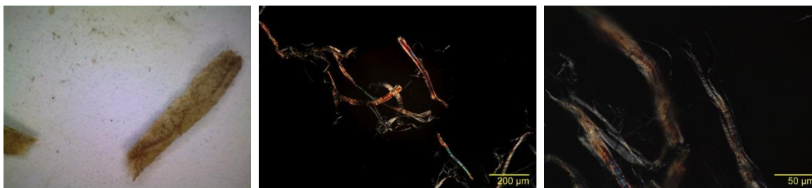
Figura 2. Caracterización de la muestra UPGD-003-01. Zona de toma de muestra de soporte, observación bajo luz normal (50X; Izquierda). Sección longitudinal de las fibras, bajo luz transmitida polarizada (100X; Centro y 400X; Derecha). (Archivo fotográfico CNCR. Fotógrafo: V. Godoy, 2020).
