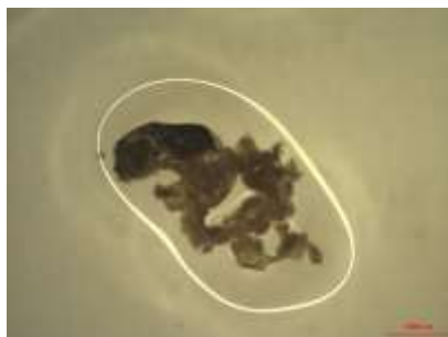
Prueba de solubilidad de una muestra del adhesivo (Stabler, 2014)
