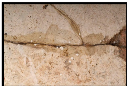
Figura 46. Detalle de adherencia de gotas de pintura blanca al interior del objeto Pre- intervención (LAD455.23) (Fotografías: V. Rivas, 2016. Archivo CNCR).
