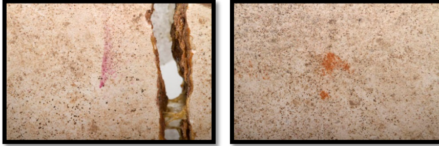
Figura 35 a y b. Detalle de adherencia color fucsia y anaranjado Pre-intervención (LAD454.27 y LAD454.29 respectivamente) (Fotografías a y b: V. Rivas, 2016. Archivo CNCR).
