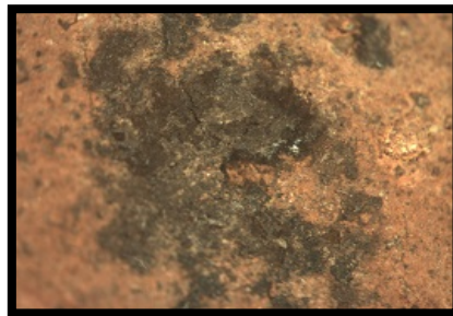
Figura 66. Detalle de adherencia de hollín al exterior del contenedor observada bajo microscopio Pre-intervención (LAD456.41) (Fotografía a: V. Cancec, 2016. Archivo CNCR).
