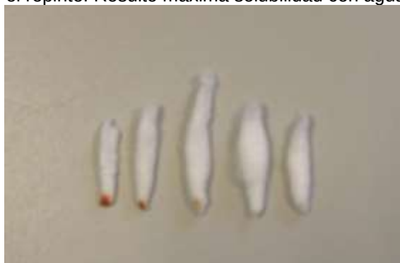
Figura 4. Resultados de la pruebas de solubilidad. Desde la izquierda: agua destilada tibia, agua destilada fría, etanol, acetona, isooctano.
