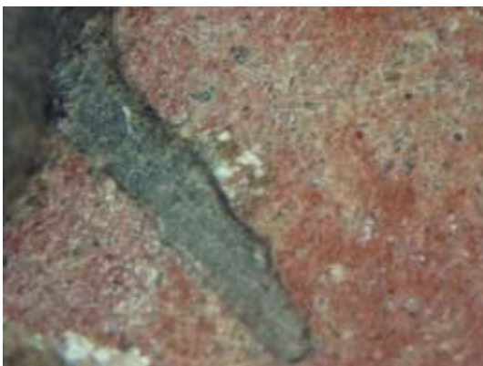
Detalle de huella de inclusión en la pasta
