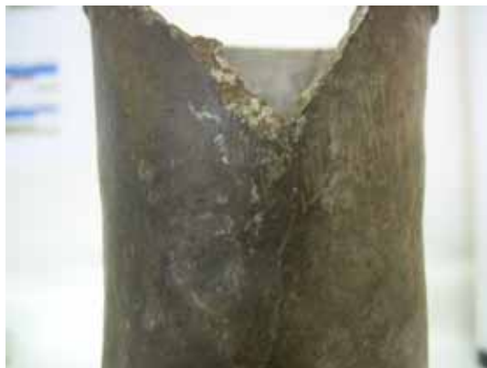
Exceso de adhesivo
