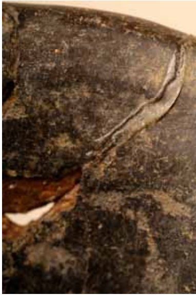
Exceso de adhesivo
