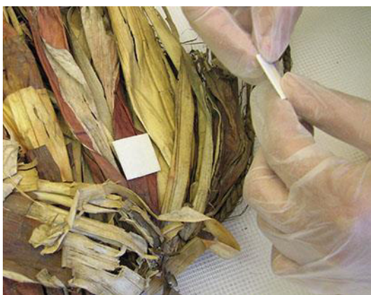
Imagen nº 39: Aplicación de papel secante humedecido para test de solubilidad de pigmentos.
