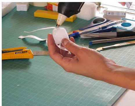
Imagen nº 30: Confección de apoyos para suspender la pieza y evitar deformación de plumas
