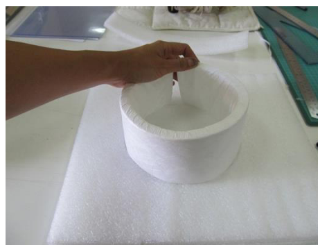
Imagen nº 29: Fijación de molde (cinta de ethafoam® forrado con Tyvek®) sobre calado circular
