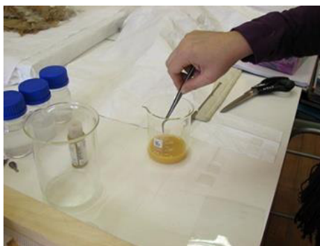
Imagen nº 41: Teñido de papel japonés con acrílico disuelto en agua desmineralizada.
