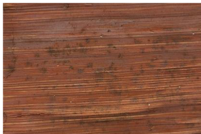
Imagen nº 33: Detalle de manchas oscuras en corteza de fibra de plátano.
