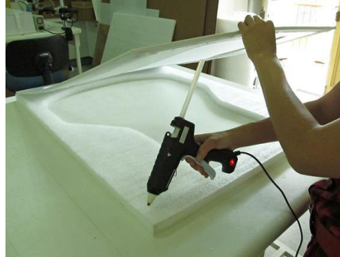
Imagen nº50: Cobertura de bandeja interior con plancha de polipropileno alveolar.
