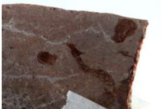
Detalle exceso de adhesivo en la superficie de la pieza. (Rivas, 2013)
