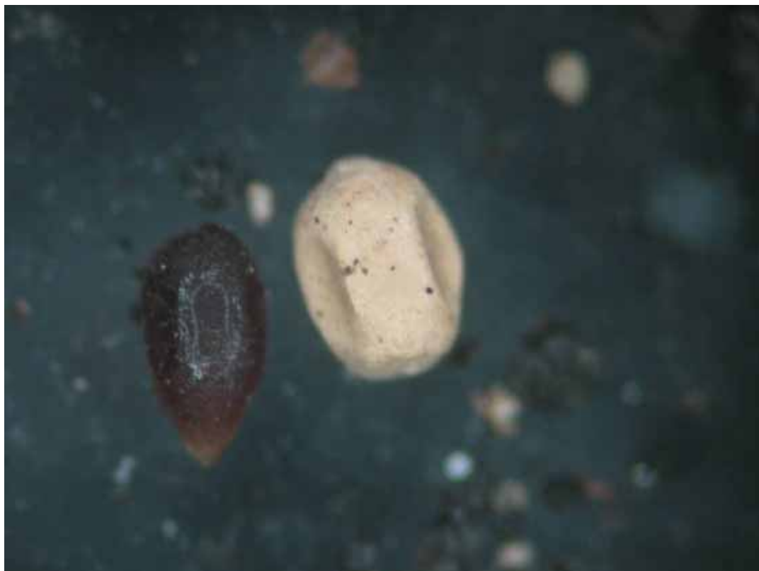
Fig.11 Residuos correspondientes a fecas de termitas, bajo lupa binocular.
