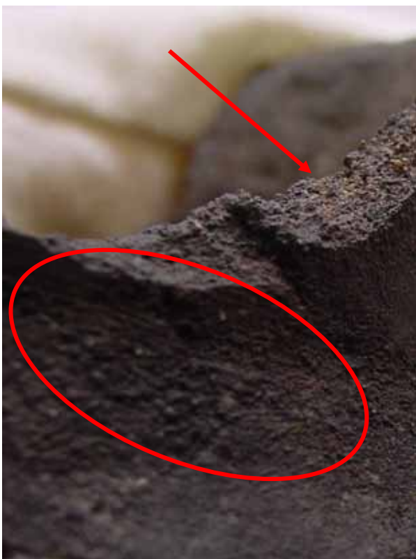
Fig. 7 Huellas de arrastre de partículas y oscurecimiento en secciones de fragmento expuestas.
