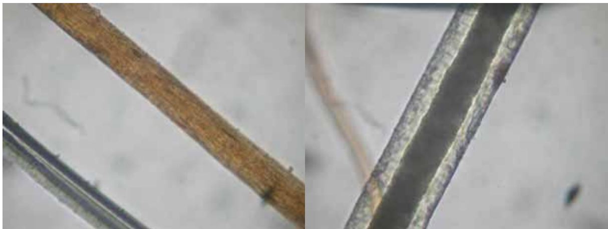
Fig. 15 y 16 Detalle fibras de pelo animal a 400x.
