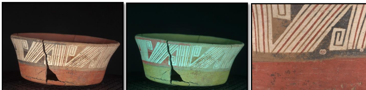
Fig. 12: De derecha a izquierda, Imagen con luz visible, imagen bajo análisis FCIR y detalle de alteración cromática. (Fotografía. P. Monteverde, y T. Pérez, 2017 Archivo CNCR.)
