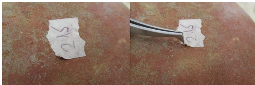
(Fig. 190) Proceso de retiro de cinta adhesiva. (Fotografía: B. Reyes, 2016. Archivo CNCR)
