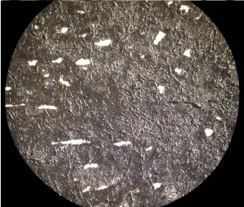
Figura 15. Detalle de zonas de saturación de tintas que permite la observación de las fibras largas del papel en la obra Les Provinciales . (Zaragoza, M., 2012)
