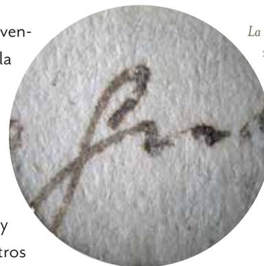
*La Pavlova y los niños*. Detalle micro fotográfico; se observa un leve halo alrededor del trazo de tinta ferrogálica (diámetro campo visual: 11mm).
