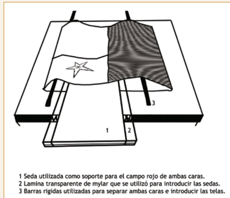
Diagrama de apertura de la bandera para la inserción de las telas de soporte.
