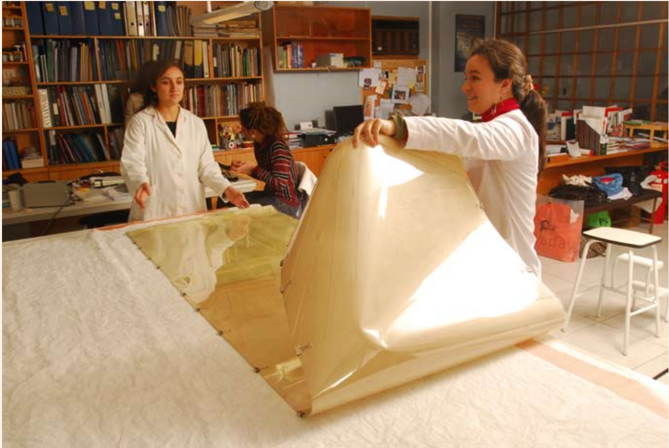
Preparación de telas de soporte azules y blancas entre láminas de mylar. (Fotografía: Javier Godoy)
