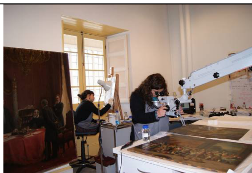
Realización de test de solubilidad: observación bajo lupa binocular. (G. Reveco, 2013. LPCD 541.028)
