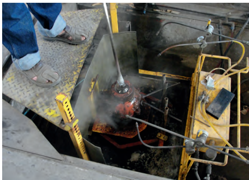
Figura 22. Mecanización del proceso de enfriamiento de moldes.
