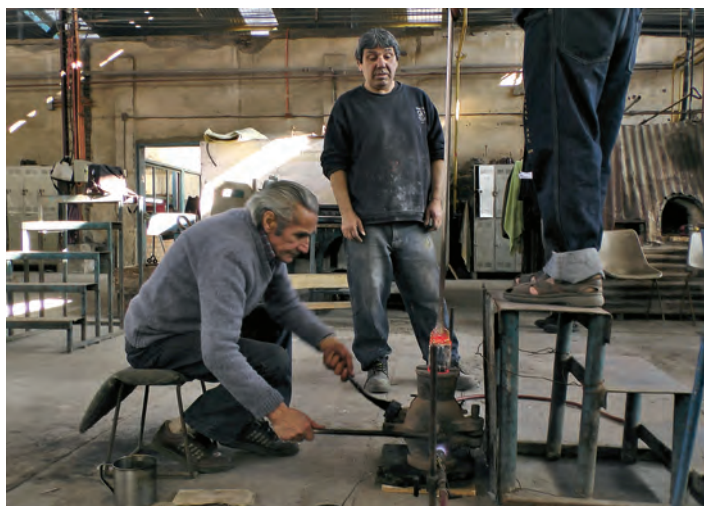
Figura 21. Moldero encargado de abrir y cerrar el molde, el que a su vez está siendo temperado por un soplete.
