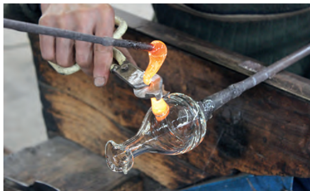
Figura 19. Tijeras cortadoras de pasta de vidrio.
