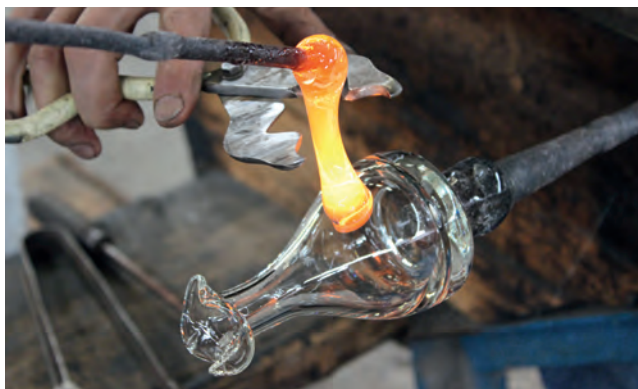
Figura 19. Tijeras cortadoras de pasta de vidrio.
