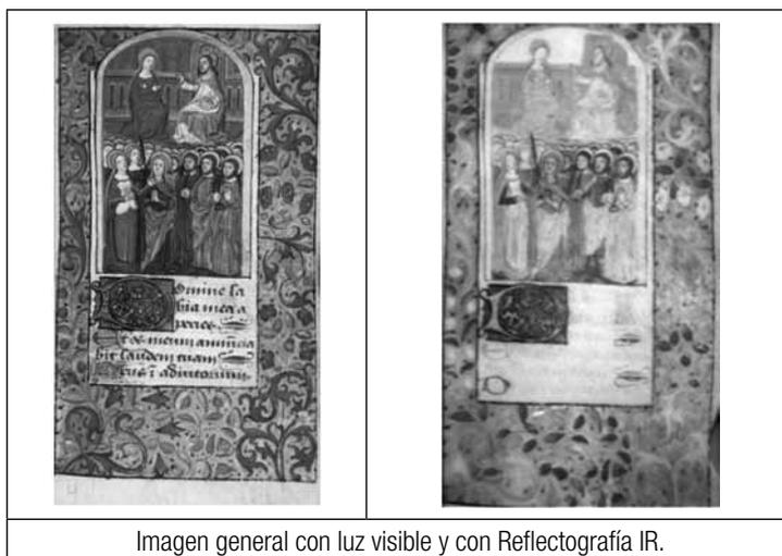
Para la realización de la reflectografía infrarroja realizada en el CNCR, se utilizó el equipo Hamamatsu C2847, con filtro IR 89 con iluminación de luz Hamamatsu C1385-02 con la técnica de radiación reflejada. Extracto de informe CNCR
