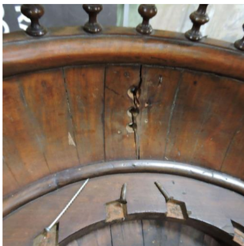
Detalle del área de fractura, esta se ubica en los pies de la cuna. Se trata de una fractura principal que mide 26 centímetros y se desplaza paralela a la junta de unión de dos piezas. La segunda fractura de menor tamaño mide alrededor de 4 centímetros va párllea a la junta y desaparece en la junta.
