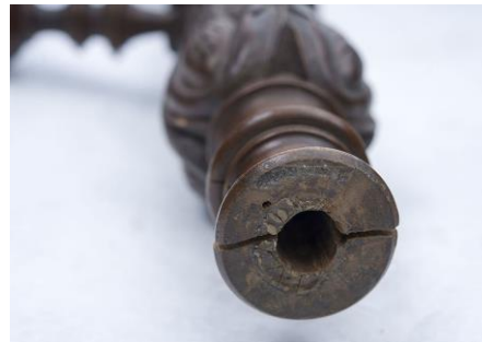
Fractura en una de las áreas de ensamble en la pata derecha de la pieza
