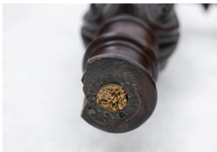
Detalle de tarugo quebrado en el interior de un ensamble de una de las patas, la pieza en cuestión se ensambla con una base inferior que le otorga estabilidad al objeto.
