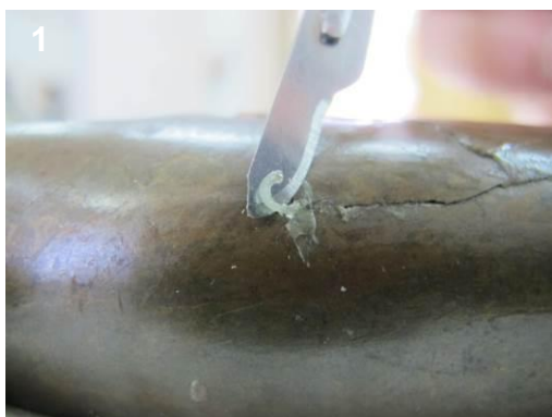
Figura 124. Eliminación físico-mecánica con bisturí de sustancias adhesivas extemporáneas: (1) Restos de adhesivo tipo cianoacrilato, (2) Depósito de yeso o sustancia similar (Fotografías: Royo, C. 2016. Archivo CNCR).
