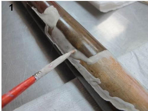
Figura 126. Limpieza físico-química del redorado con emulsión W/O, siendo la fase dispersa una solución acuosa tamponada a pH 6,5 y la fase dispersante isooctano: (1) Aplicación de la emulsión con pincel, (2) Frotamiento con hisopo de algodón en movimientos circulares, (3) Retirada en seco con hisopos de algodón, (4) Eliminación de residuos con isooctano (Fotografías: Royo, C. 2016. Archivo CNCR).
