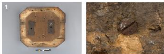
Figura 14. Alteraciones de la cubierta y pieza interior de la base de la peana: (1) Fractura que abarca prácticamente la dimensión total del tablero. Además, se observa la presencia de líneas realizadas con lápiz mina en los tableros interiores y un aspa con tiza o creta blanca en la pletina metálica derecha (2) Corrosión activa de la cabeza de los tornillos de la cubierta de la base de la peana, que también puede observarse en las pletinas de la figura 1 (Fotografías: Archivo CNCR, Ormeño, L., 2016 (1); Archivo CNCR, Pérez, T., 2016 (2)).
