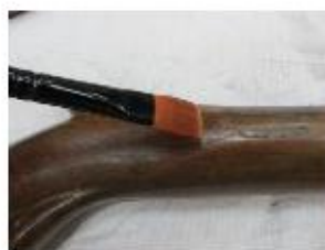
Figura 17. Aplicación de capa de protección por pincelado con Paraloid B72® al 5% en acetato de etilo (Fotografía: Archivo CNCR, Royo, C., 2016).
