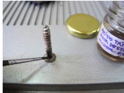
Aplicación por impregnación de ácido tánico en tornillo. (Miori, G. 2016. Archivo CNCR)
