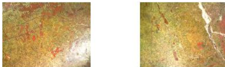
Figura 4. Color tendiente al verdoso de la lámina metálica del estrato de redorado (Microscopio digital Dino-Lite®) (Fotografías: Archivo CNCR, Royo, C., 2016).
