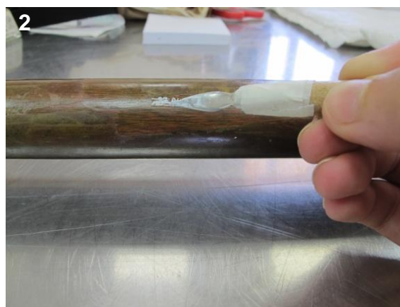
Figura 130. Aplicación de capa de protección por pincelado con Paraloid B72® al 5% en acetato de etilo (Fotografía: Royo, C. 2016. Archivo CNCR).
