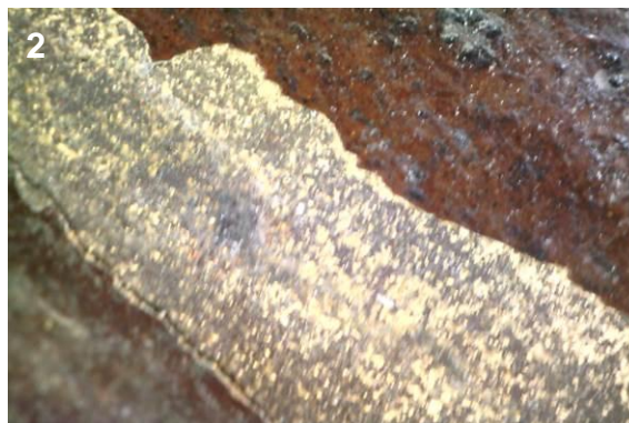
Figura 49. Secuencia estratigráfica de la peana: (1) Diferentes estratos observables a través de los faltantes del estrato de policromía, (2) Lámina metálica de color dorado bajo los estratos de marrones observada con Microscopio Digital Dino-Lite® (Fotografías: Pérez, T. 2016. Archivo CNCR (1); Royo, C. 2016. Archivo CNCR (2)).
