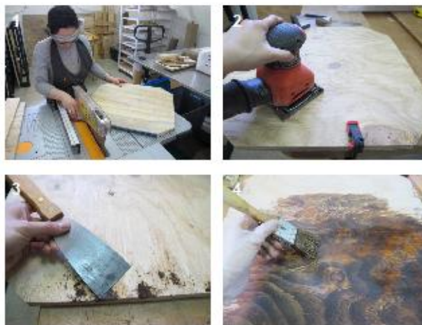
Figura 32. Reposición de la cubierta de la base de la peana: (1 y 2) Reproducción de la cubierta en terciado laminado de tipo estructural de 20 mm, retocado con lijadora orbital, (3) Relleno de huecos o astillados, mediante espátulado de pasta de serrín de madera de nogal (por su color más oscuro) y cola de conejo al 7% en agua destilada (con 2-3 gotas de antifermentativo Eugenol®), (4) Tinte con extracto de nogal al 5% en agua destilada mediante dos aplicaciones por pincelado, (5) Aplicación de una capa de barniz de poliuretano mate por pincelado (Fotografías: Archivo CNCR, Miori, G., 2016).
