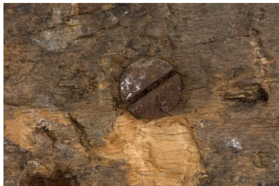
Figura 71. Alteraciones de la cubierta y pieza interior de la base de la peana: (1) Fractura que abarca prácticamente la dimensión total del tablero. Además, se observa la presencia de líneas realizadas con lápiz mina en los tableros interiores y un aspa con tiza o creta blanca en la pletina metálica derecha (2) Corrosión activa de la cabeza de los tornillos de la cubierta de la base de la peana, que también puede observarse en las pletinas de la figura 1 (Fotografías: Ormeño, L. 2016. Archivo CNCR (1); Pérez, T. 2016. Archivo CNCR (2)).
