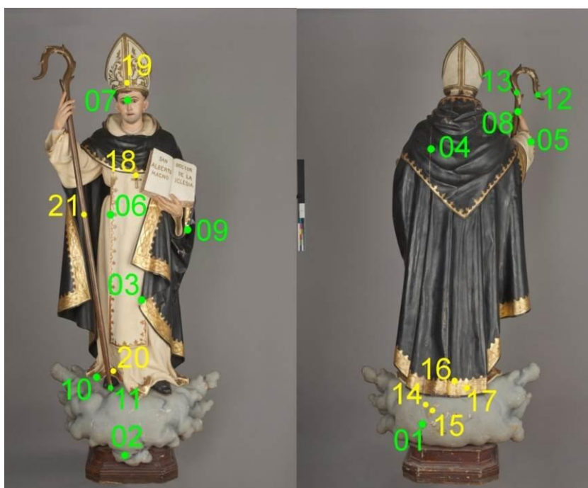
Figura 1. Zonas de toma de muestra de la obra LM-077. Los puntos en verde corresponden a muestras extraídas de la obra, mientras que los amarillos corresponden a puntos de medición para fluorescencia de rayos X (Archivo fotográfico CNCR. Fotógrafo: L. Omeño, 2016).
