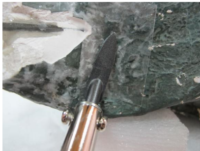
Aplicación de ciclododecano en las zonas perimetrales a la reintegración volumétrica como capa de protección. En la imagen izquierda, primera aplicación en caliente; en la imagen derecha, generación de una capa de cristales homogéneos con una segunda aplicación de calor con espátula caliente, protegiendo la zona con film ignífugo transparente. (Fotografías: Archivo CNCR, Royo, C., 2015)
