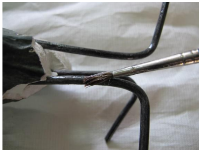
Pincelado de Paraloid B44® al 30% en acetato de etilo en las barras metálicas de la estructura interna. (Fotografías: Archivo CNCR, Royo, C., 2015)
