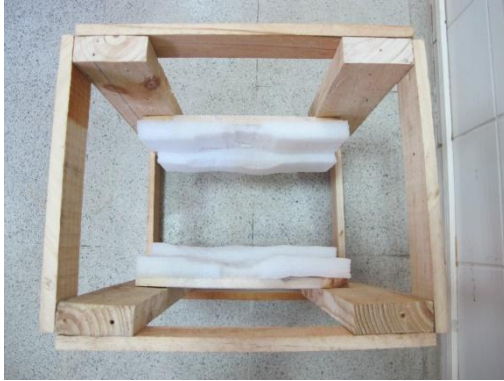
Vista superior (imagen izquierda) y vista inferior (imagen derecha) de la estructura de madera de pino rabiata con protecciones de Ethafoam®. (Fotografías: Archivo CNCR, Miori, G., 2015)
