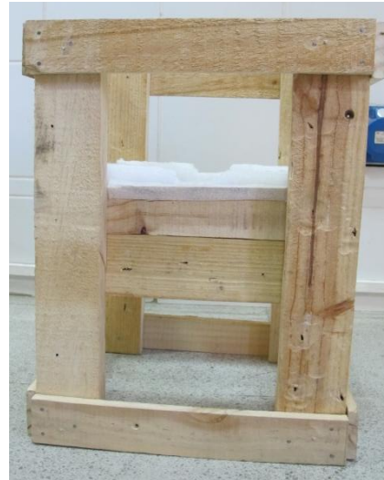
Vista frontal (imagen izquierda) y lateral derecha (imagen derecha) de la estructura de madera de pino rabiata con protecciones de Ethafoam®. (Fotografías: Archivo CNCR, Miori, G., 2015)
