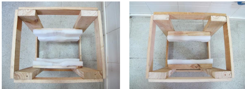
Vista superior (imagen izquierda) y vista inferior (imagen derecha) de la estructura de madera de pino rabiata con protecciones de Ethafoam®. (Fotografías: Archivo CNCR, Miori, G., 2015)
