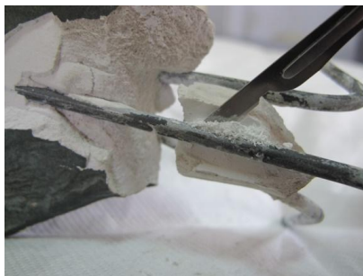
Eliminación del fragmento de yeso que unía las tres barras metálicas de la estructura interna. (Fotografías: Archivo CNCR, Royo, C., 2015)
