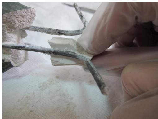
Eliminación del fragmento de yeso que unía las tres barras metálicas de la estructura interna. (Fotografías: Archivo CNCR, Royo, C., 2015)
