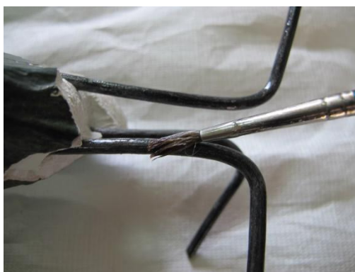
Pincelado de Paraloid B44® al 30% en acetato de etilo en las barras metálicas de la estructura interna. (Fotografías: Archivo CNCR, Royo, C., 2015)
