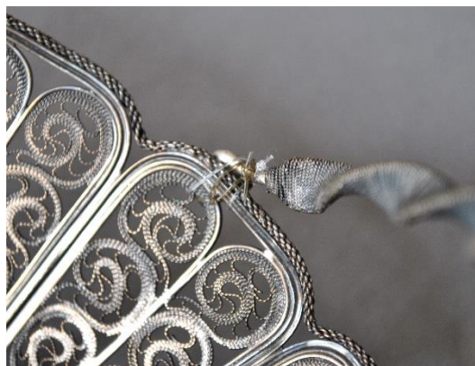
Estado inicial, detalle: corrosión negruzca y amarra con hilo de pescar
