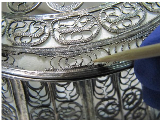
Unión de alambres fracturados con adhesivo
