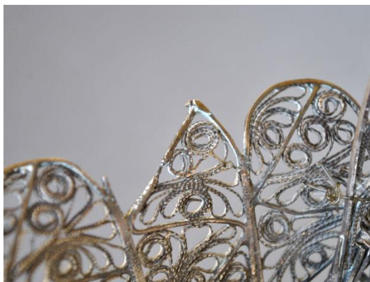
Estado inicial, detalle: faltante en el borde y corrosión verdosa
