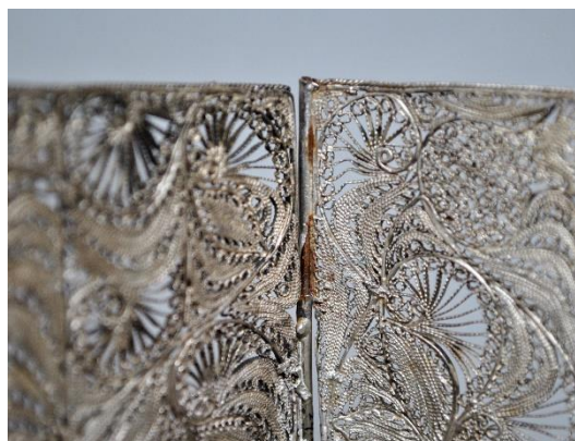
Estado inicial, detalle: Corrosión de hierro y rasgadura en bisagra
