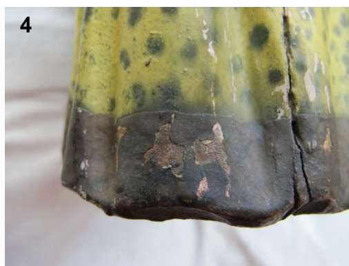
Figura 55. Tratamiento de los puntos de corrosión activa: (1) Eliminación físico-mecánica con bisturí en la medida de lo posible, (2) Protección con Paralaid B44® al 30% en acetato de etilo en una única aplicación, (3 y 4) Antes y después del tratamiento de una zona de la cenefa dorada con corrosión activa (Fotografías: Royo, C. 2016. Archivo CNCR).
