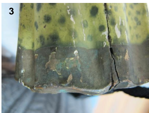
Figura 55. Tratamiento de los puntos de corrosión activa: (1) Eliminación físico-mecánica con bisturí en la medida de lo posible, (2) Protección con Paralaid B44® al 30% en acetato de etilo en una única aplicación, (3 y 4) Antes y después del tratamiento de una zona de la cenefa dorada con corrosión activa (Fotografías: Royo, C. 2016. Archivo CNCR).
