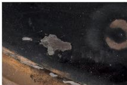
Lagunas de laca en la parte superior. (Archivo CNCR, Rivas, V., 2013)
