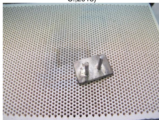
Creación del cierre con una placa y dos hilos de plata. (Archivo CNCR, Csillag, C.,2013)
