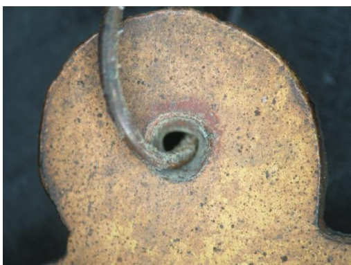
Oxidación del alambre, contaminando el orificio. Vista bajo microscopio óptico Stemi 2000-C, con aumento 5x. (Archivo CNCR, Chiostergi S., 2013)
