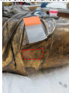
Gel de ácido cítrico A. 5 minutos (Archivo CNCR, Chamoux, C. 2013)
