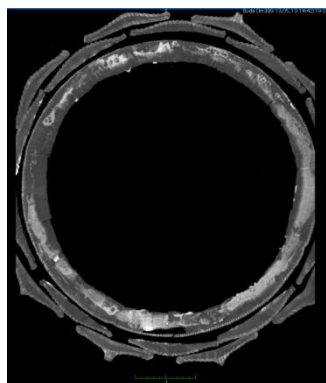
Vista superior de la base. Las zonas más claras corresponden al adhesivo presente entre la tabla superior y el cono superior. (Tomografía computarizada: Hospital Clínico de la Universidad de Chile /Archivo CNCR, 2013)
