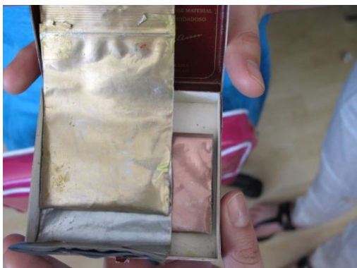
Polvos metálicos de bronce, plata y cobre, comúnmente llamados purpurinas. (Archivo CNCR, Chamoux, C., 2014)
