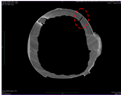
Fenda radial de la madera, ubicada en el bloque anverso que forma el vientre. (Tomografía computarizada: Hospital Clínico de la Universidad de Chile /Archivo CNCR, 2013)
