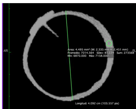
Imagen del TAC de una de las pulseras, con aplicación un filtro para ver metales. Se notan el clavo la flor y la pulsera misma. (Tomografía computarizada: Hospital Clínico de la Universidad de Chile /Archivo CNCR, 2013)
