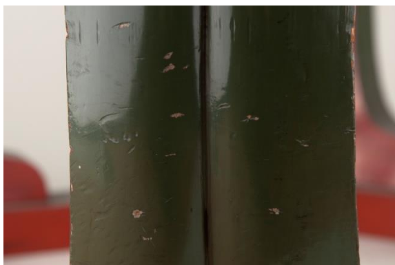
Picaduras en la pintura (Archivo CNCR, Rivas, V. 2013)
