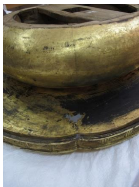
Nivelación de la superficie con resane negro. (Archivo CNCR, Chamoux, C.,2013)
